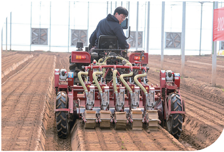
在苏州市新丰现代农业园，自动导航驾驶起垄播种一体机正在进行蔬菜直播作业。
