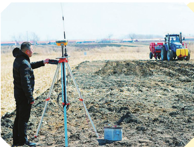
公主岭市认真总结和推广“梨树模式”,加大黑土地保护力度,推广先进适用技术,全力备春耕。图为公主岭市顺民农民专业合作社利用北斗导航系统移动基站定位农机播种方向和速度。石雷/摄
