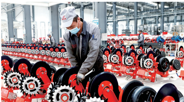
瑞丰重工生产车间内工人正在对免耕播种机进行安装作业
